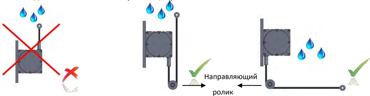
4. Не допускается вытягивать тросик под углом. При необходимости использовать направляющие ролики.
